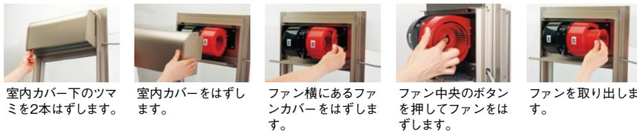
室内カバー下のツマミを2本はずします。 室内カバーをはずします。 ファン横にあるファンカバーをはずします。 ファン中央のボタンを押してファンをはずします。 ファンを取り出します。
